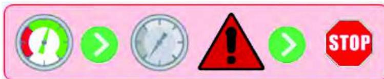
Avec cette sélection, si la pression descend en dessous du seuil minimum la machine s'arrête, la vanne est fermée et l'alarme de pression est donnée. La machine se met en état de STOP et ne peut repartir qu'après l'intervention d'un opérateur.
