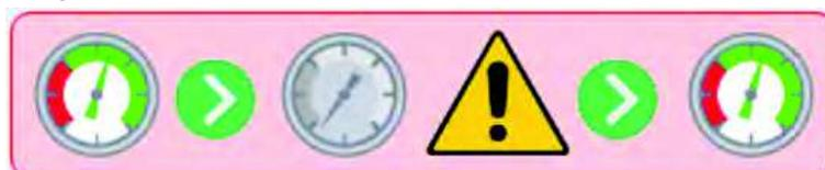
Avec cette sélection, si la pression descend au-dessous du seuil minimum la machine s'arrête, ferme la vanne d'entrée et attend l'augmentation de la pression au-dessus du seuil minimum, pour rouvrir la vanne et recommencer le cycle (la machine reste dans l'état de START). Il n'y a pas de limites au nombre d'arrêts.
