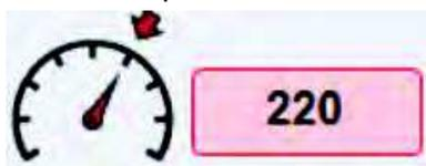
**Potentialité** : valeur pour la gestion du réglage de vitesse, comme point de départ il est possible d'utiliser la vitesse maximum de la machine. Si le réglage est très lent, il faut diminuer la valeur, si au contraire le système corrige trop brusquement sans stabiliser la vitesse (oscillation), il faut augmenter la valeur.
